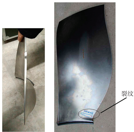
图16 磨除叶尖进气道封焊层的2#试验件及试验结果
