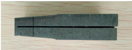
图17 TC4试样级电子束焊接工艺验证结果
